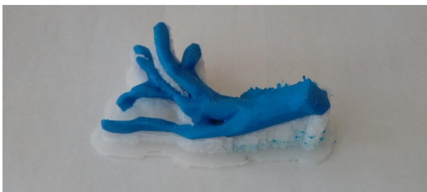
Rys 6.17 Gotowy wydruk żył umieszczony na podporach
