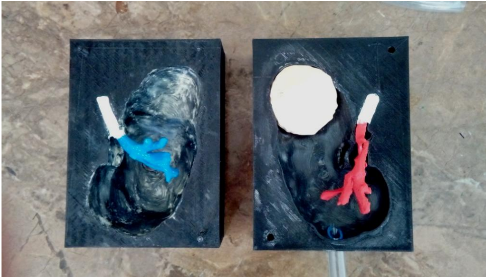
Rys. 6.30 Dwie części formy z umieszczonymi elementami guza, żył i tętnic
