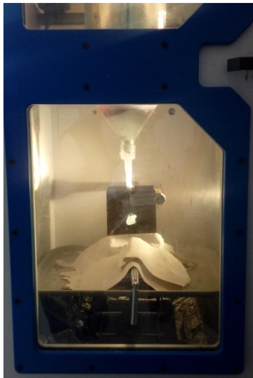
Rys. 6.33 Widok na komorę próżniową z umieszczoną formą i zamontowanym odpowietrzeniem
