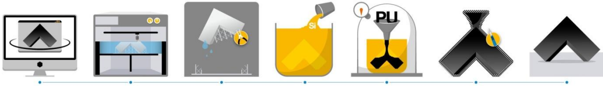
Rys. 3.5 Przedstawienie procesu wytwarzania formy silikonowej oraz modelu z żywicy poliuretanowej [31]
