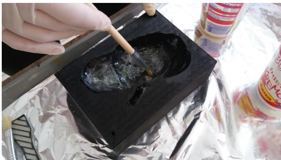
Rys. 6.29 Zabieg pokrywania negatywu żywicą poliuretanową
