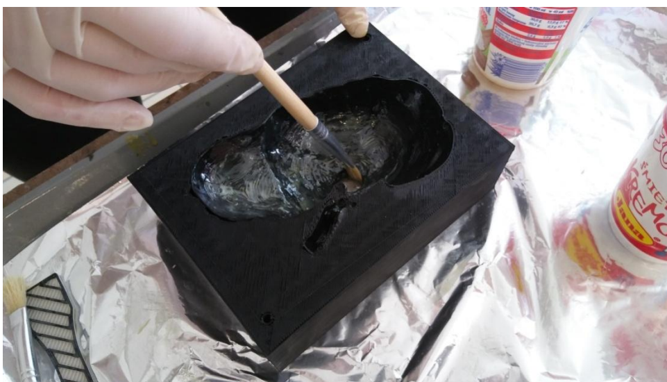
Rys. 6.29 Zabieg pokrywania negatywu żywicą poliuretanową
