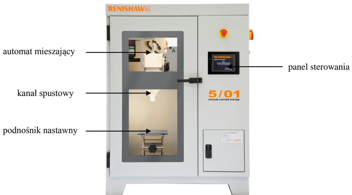
Rys. 3.6 Rozmieszczenie komponentów w komorach maszyny do odlewania próżniowego [opracowane na podstawie: 32, 33]
