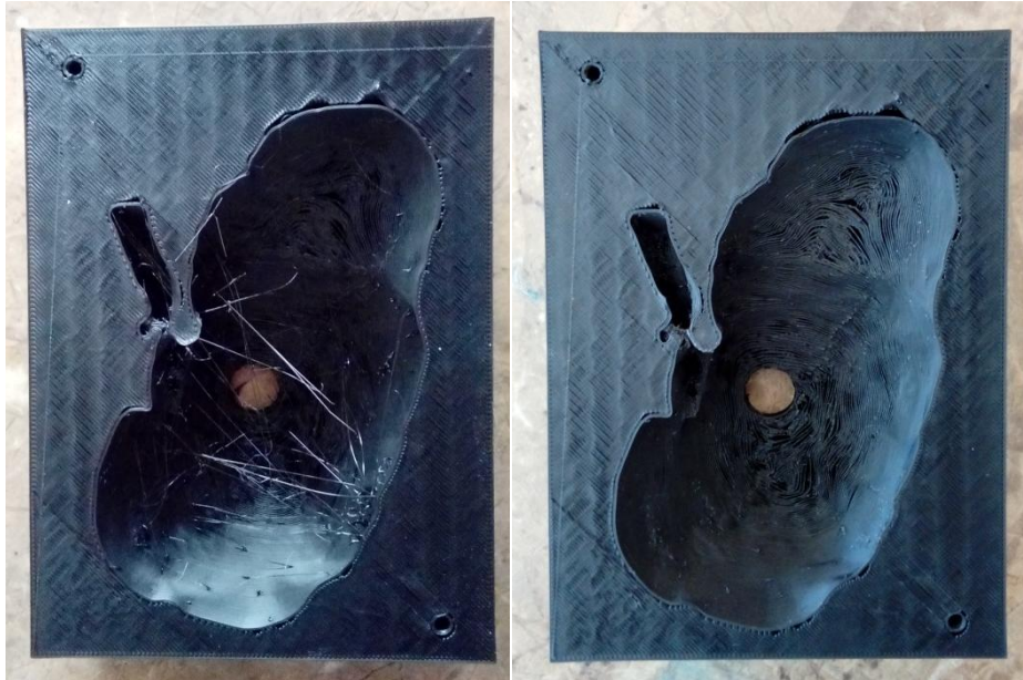
Rys. 6.28 Porównanie formy przed usunięciem zbędnego materiału (lewo) i po (prawo); widoczne dziury niespolonych obrysów warstw (prawo)
