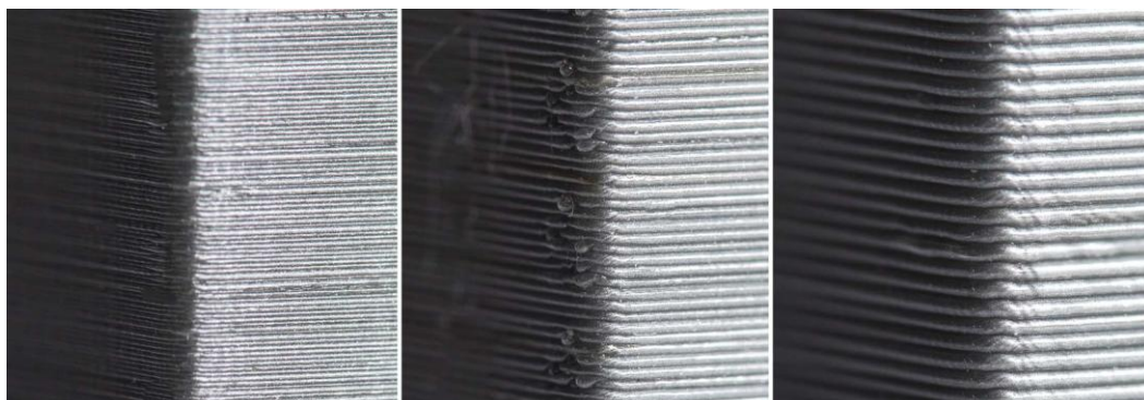
Rys. 3.4 Porównanie grubości warstw; od lewej: 0,05 mm, 0,2 mm, 0,3 mm [30]
