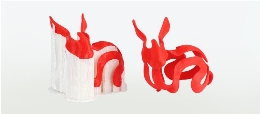
Rys. 3.3 Od lewej: model z podporami oraz model z usuniętym materiałem podporowym [29]
