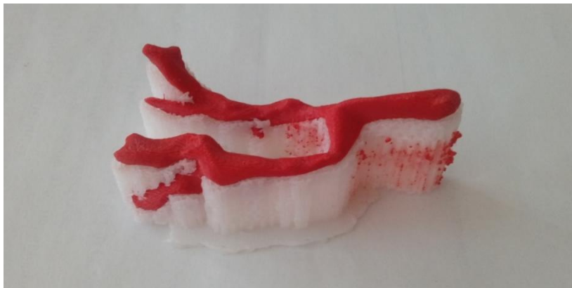
Rys. 6.19 Gotowy wydruk tętnic, umieszczony na podporach
