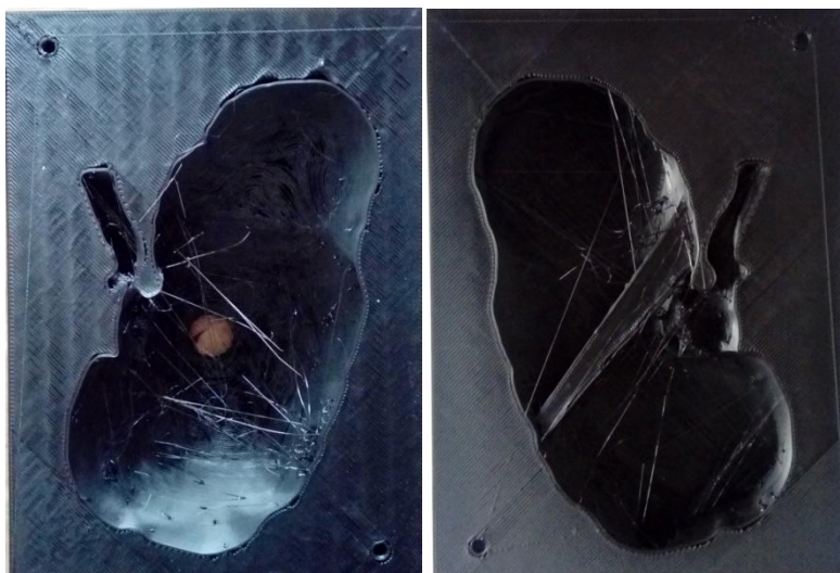
Rys. 6.27 Wydrukowane części formy; po prawej stronie model z widocznym błędem wydruku
