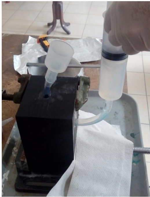
Rys. 6.32 Proces odlewania silikonu
