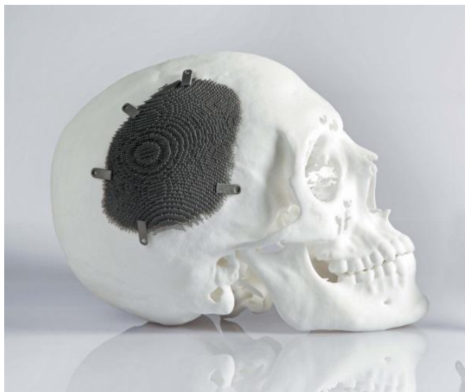
Rys. 3.9 Implant czaszki wykonany metodami przyrostowymi dla pacjenta z Argentyny [37]
